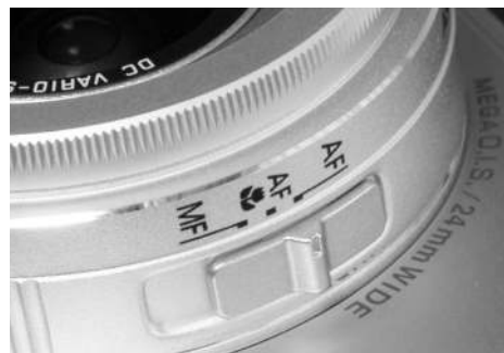
Prominent platziertes Schiebeschalter links am Objektiv für Focussier-Betriebsart: AF, AF-Macro, Manuell
