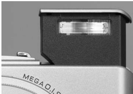
Der Blitzreflektor wird oben ausgefahren, was die Gefahr für Rote Augen reduziert
