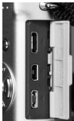
Anschlüsse hinter der Klappe an der rechten Seite: Komponenten-Video-Ausgang für optimale Wiedergabe über HD-Fernseher, allerdings ist das Kabel dafür nicht dabei. Weiters: Kombibuchse für AV und DC-In
