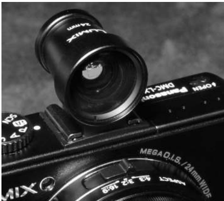
Ein Hauch von Systemkamera: Zur LX3 gibt es auch einen aufsteckbaren optischen Sucher (DMW-VF1) für die Anfangsbrennweite von 24mm äquiv. KB
