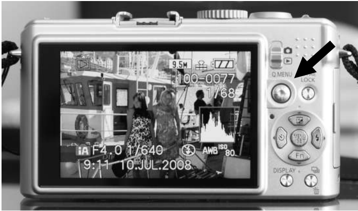
Riesiges Display auf der Rückseite der LX3. Die Bedienung ist sehr übersichtlich gelöst, wie prinzipiell schon von der LX2 vertraut. Wesentliches Element zur Menübedienung ist der Joystick-Nippel (Pfeil)
