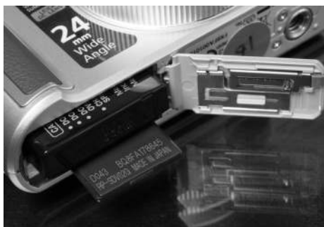
Kombifach für SD(HC)-Karte und Lithium-Ion-Akku an der Bodenplatte
