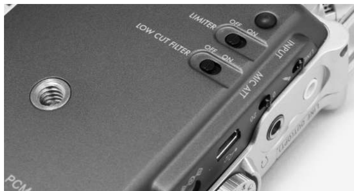
Auf der Unterseite ist der Mikrofonstativ-Anschluss, zwei Tasten – für Limiter und Low-Cut-Filter – sind hier für den Zeigefinger griffbereit
