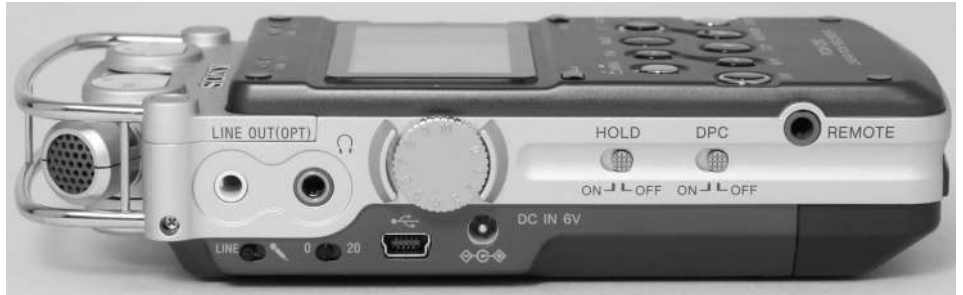
Linke Seite des Sony PCM-D50: Line-/Digital-Ausgang, Kopfhörer-Buchse, Schiebeschalter für Hold und DPC für Wiedergabe-Geschwindigkeit, Remote-Buchse für die als Zubehör erhältliche Fernbedienung, unten Umschalter zwischen Line- und Mikrofon, 20-dB-Dämpfung für Mikrofon, USB-Mini-Buchse, DC-In und darüber das Rändelrad für Kopfhörer-Lautstärke
