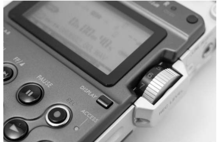
Riesiges Rändelrad mit Skala für Aufnahmepegel beim PCM-D50
